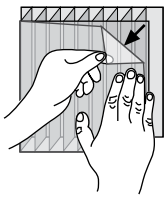
Иллюстрация 17а Частичное или полное удаление защитной пленки перед установкой и после нее
